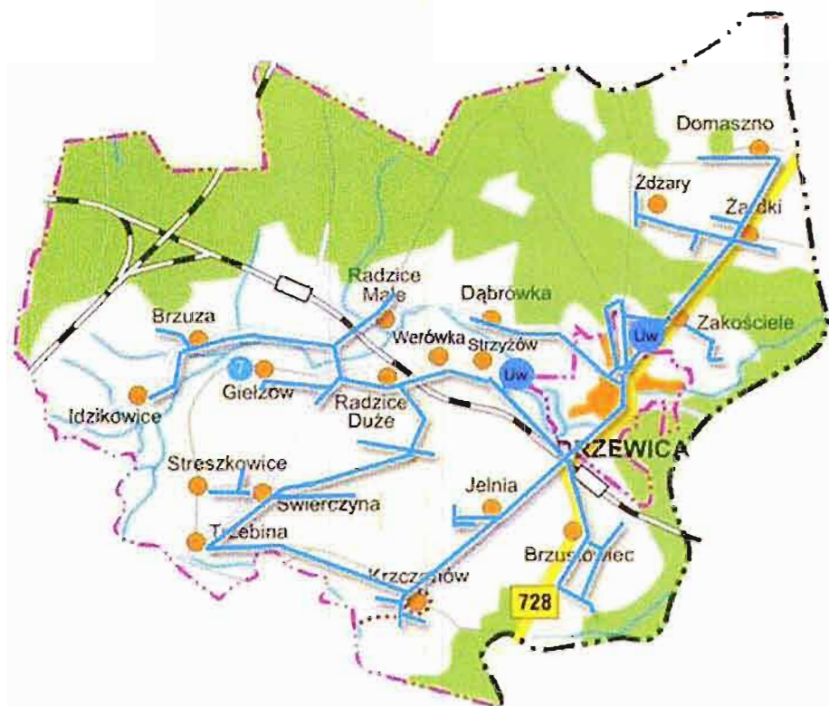
Mapa nr 1. Gmina i Miasto Drzewica z podziałem na sołectwa, mapa obrazuje sieć wodociagową oraz ujęcia wody Uw – ujęcie wody
